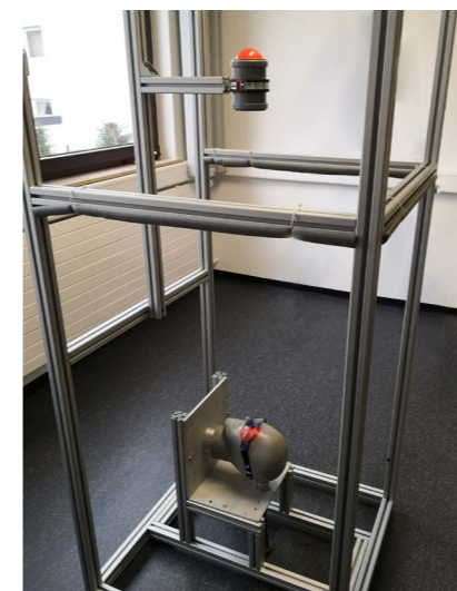
Beispiel Testaufbau (Aufprall Hockeyball aus 1 m Höhe)
